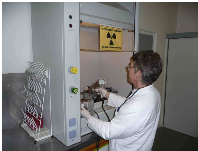
Mesure de flux de rayonnement gamma au moyen du scintillomètre SPP2
