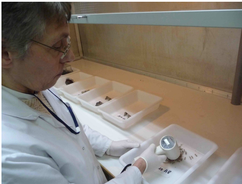
Mesure de taux de comptage alpha-bêta-gamma au moyen du MCB2
